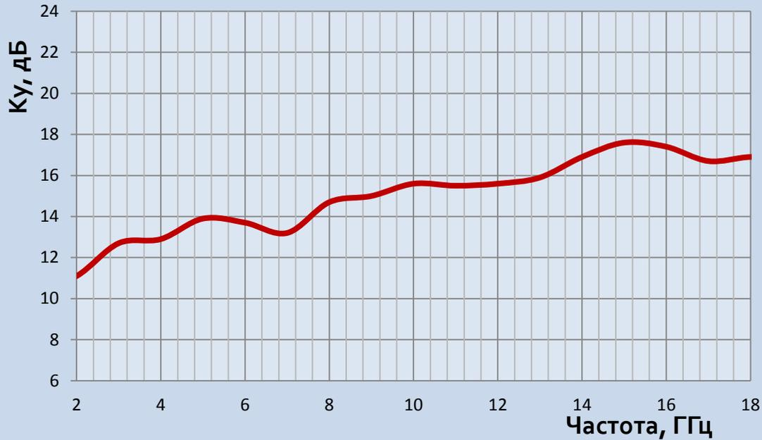
Типовой коэффициент усиления (канал 2)
