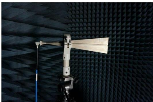
Фото 1. Антенна П6-131 на узле крепления АК-02М
