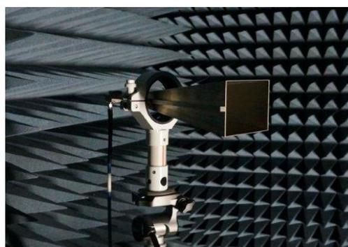
Фото 2. Антенна П6-131 на узле крепления АК-02М
