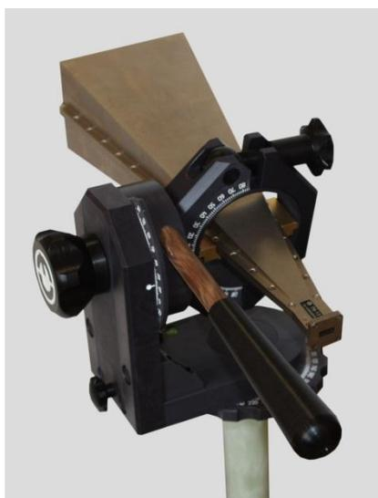
Фото 3. Антенна П6-131 на диэлектрическом штативе (ШАД-01)
