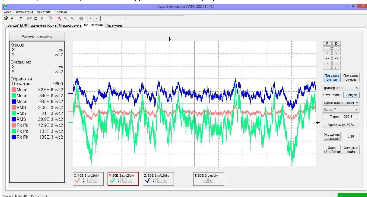
Внизу окна располагаются поля для включения/выключения вывода каналов и настройки масштаба развёртки осциллограммы. Если дважды кликнуть по полю с соответствующим каналом, то появится или исчезнет галочка, в результате чего в рабочую область
