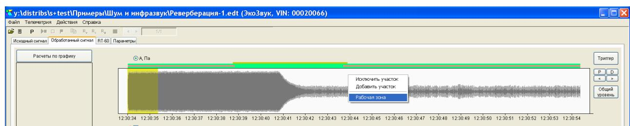
На вкладке «**Обработанный сигнал**» выделите рабочую зону так, чтобы участок спада попадал примерно в её середину.
