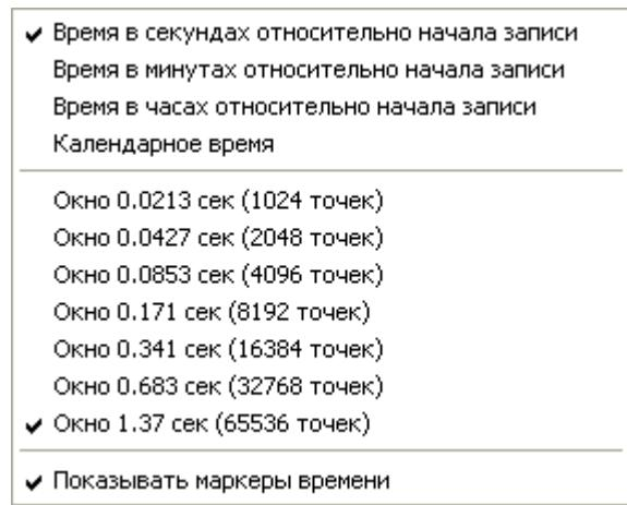
Выбор шкалы временной оси графика (доступно только при выборе опции «**Показать сигнал**»).
