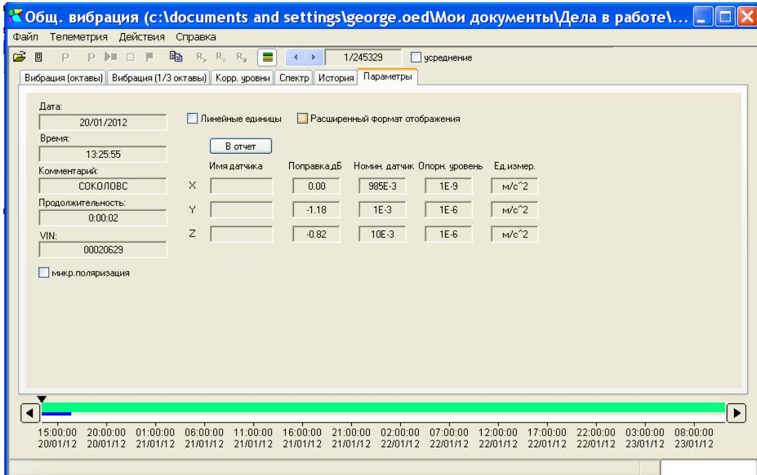
Поле «Линейные единицы» предназначено для отображения результатов измерений в табличных вкладках не в логарифмическом масштабе, а в линейном, например, в м/с<sup>2</sup>.
