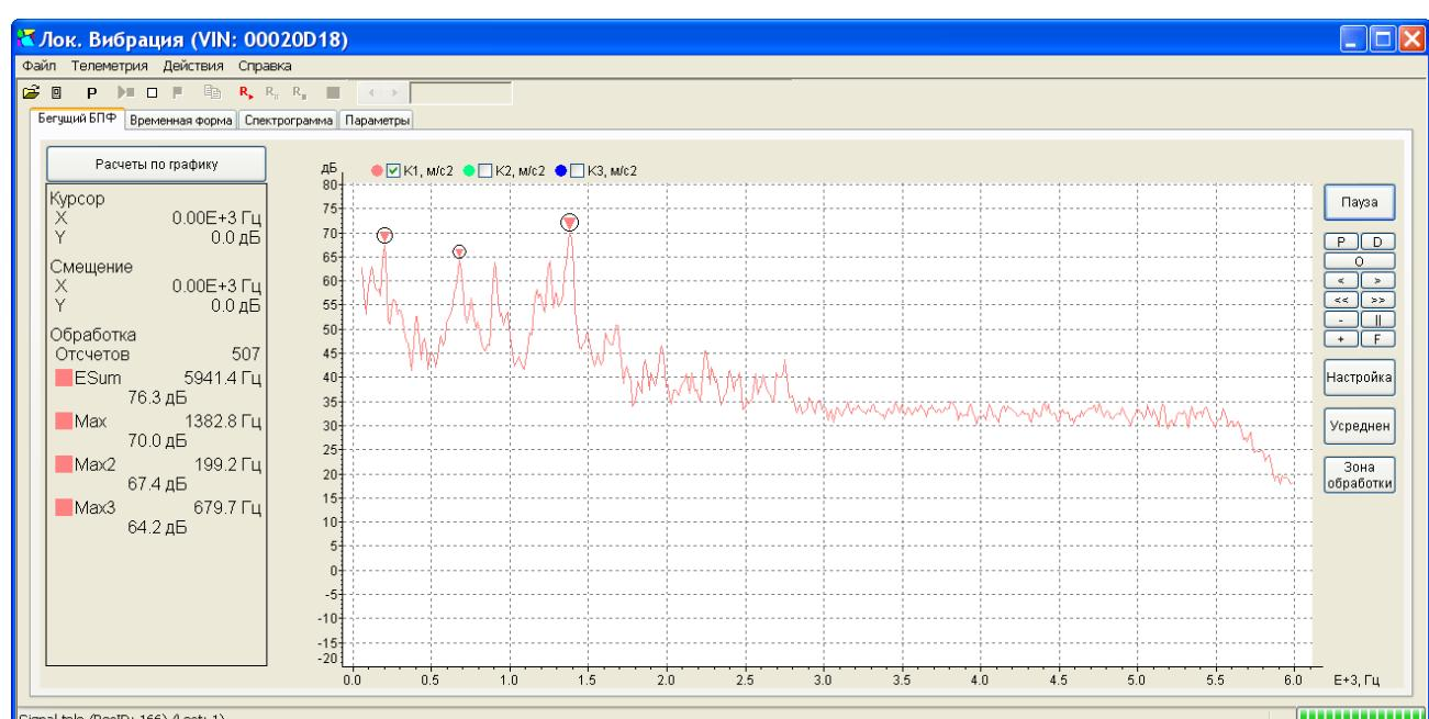
В этой вкладке представлен узкополосный спектр, рассчитываемый по временной форме сигнала.
