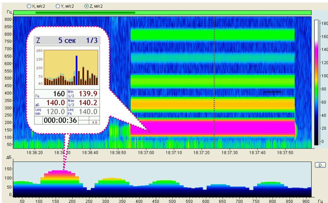
На рисунке приведен пример спектрограммы измеряемой в режиме «XYZA:ЛокВиб» вибрации, создаваемой виброкалибратором (основной сигнал - 140 дБ на 160 Гц - красная полоса спектрограммы - и его существенно более слабые гармоники - желтая и зеленые полосы).
