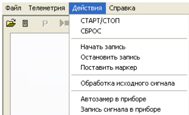
Меню **Действия** содержит команды для дистанционного управления процессом телеметрии прибора, который подключен к компьютеру (см.п.10).
