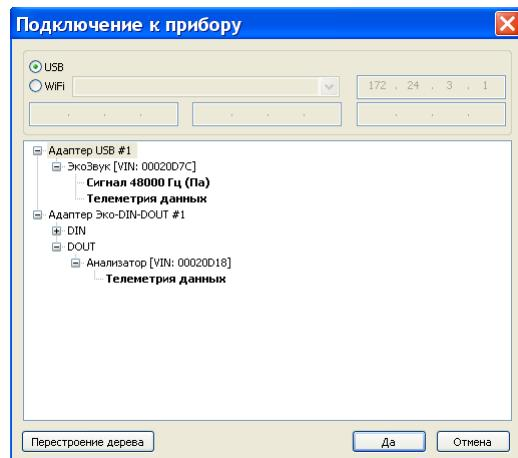
В появившемся окне «Подключение к прибору» щелкните кнопку **Перестроение дерева**. Программа покажет все доступные на данный момент источники и виды телеметрии.
