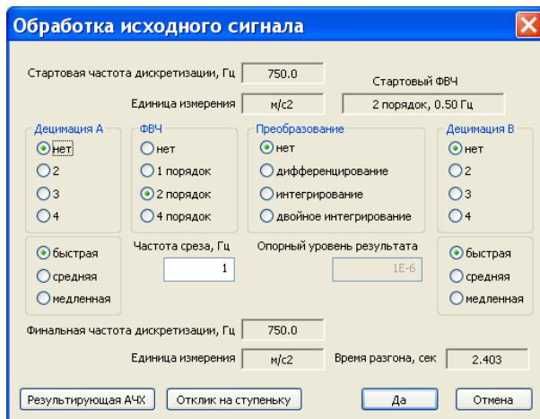
**Стартовая частота дискретизации:** частота дискретизации исходного сигнала.
