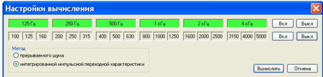
В этом окне вы можете выбрать, для каких частотных полос производить расчет времени реверберации. Клавиши **ВКЛ** и **ВЫКЛ** включают (или выключают) в расчет все поля соответствующего ряда. Те поля, по которым будет производиться расчет времени реверберации, выделены зеленым цветом. Чтобы включить или выключить отдельное поле (полосу частот), щелкните по нему левой кнопкой мыши.
