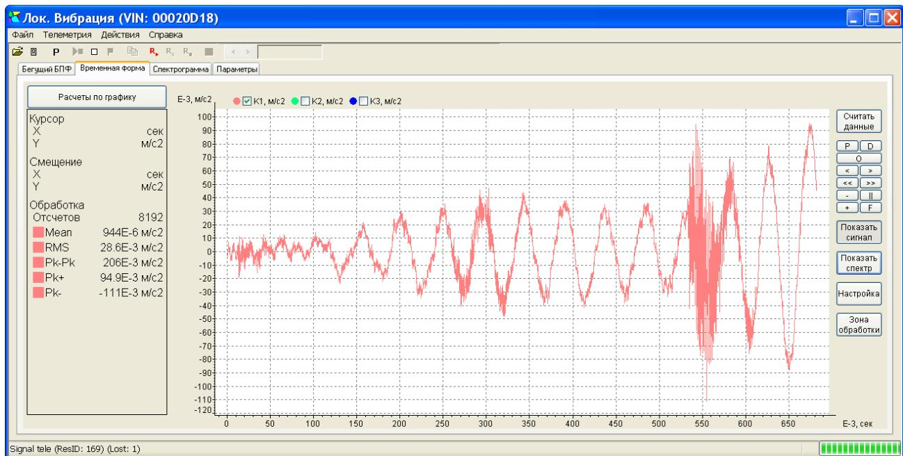
Над графиком находятся переключатели каналов (для многоканальных режимов), а также обозначения единицы измерения для каждого канала.
