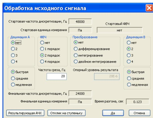
Установите параметры децимации так, чтобы финальная частота дискретизации была равна **24000 Гц**.
