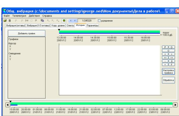
Вкладка «История» появляется при открытии файлов **Мультизаписи**, **Автозамера** и **Группового замера**, содержащих более одного измерения. Она позволяет работать с графиками изменения во времени отдельных величин.
