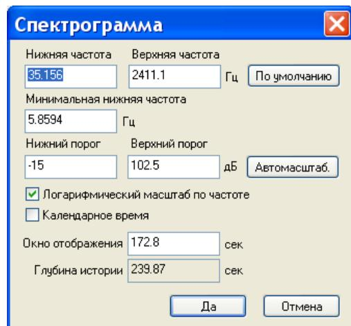
**Нижняя частота, Верхняя частота:** пределы спектрального диапазона, представленного на графике.
