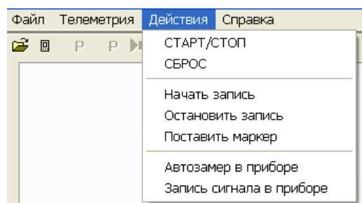
Меню **Действия** содержит команды для дистанционного управления процессом сбора данных (измеренных значений) прибора, который подключен к компьютеру по каналу телеметрии реального времени.
