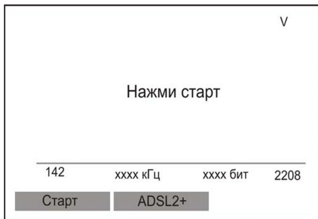
Выбор типа системы передачи осуществляется кнопкой «F2» (ADSL/ADSL2/ADSL2+ SHDSL/SHDSL.bis), запуск кнопкой «Старт».
