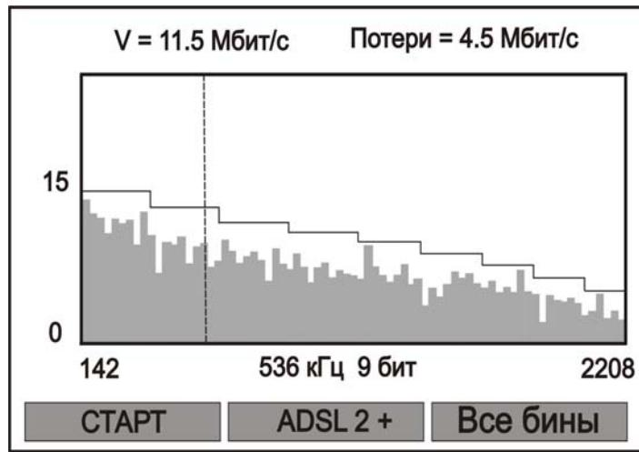
Существует возможность вывода на экран как всех бинов, так и отдельно четных либо нечетных (кнопка «F3»), а также можно осуществить быстрый пересчет измеренного скоростного потенциала для другого типа системы передачи данных без проведения новых измерений
