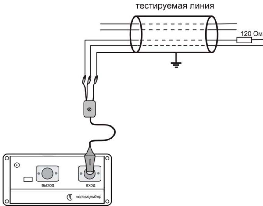
Дифференциальный вход прибора Дельта-Про подключают к исследуемой паре.
