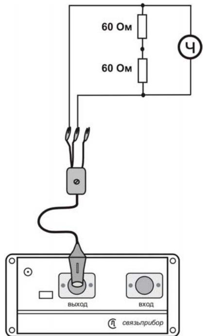
Измерения производятся для частот 8192.00 кГц и 32.00 кГц в режиме узкополосного измерения уровня. Полученные значения должны соответствовать заявленным в разделе технические характеристики настоящего руководства.
