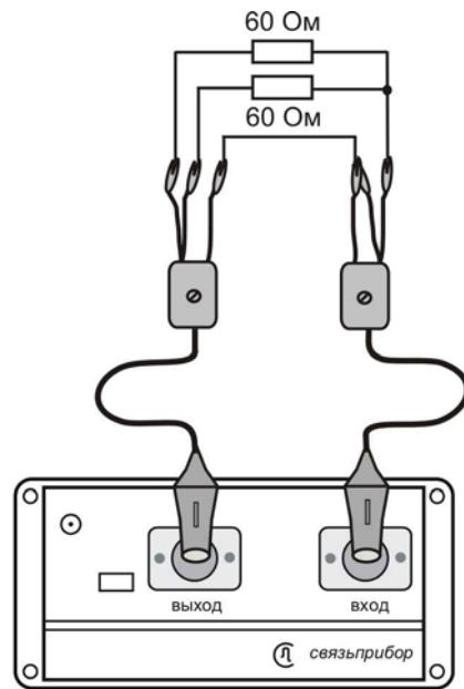
Показания прибора в режиме измерения уровня соответствуют затуханию асимметрии выхода генератора и должны быть не более -40 дБ.
