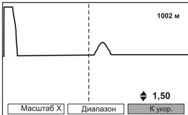
Если коэффициент укорочения неизвестен, но известна длина кабеля, установите курсор на конец кабеля. Затем, изменения коэффициент укорочения выставите расстояние до курсора равное реальной длине. Данный метод хорошо работает для кабелей без вставок.
