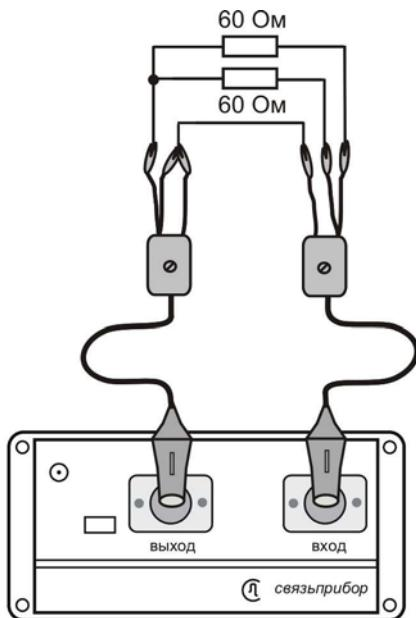
Показания прибора соответствуют затуханию асимметрии входа приемника и должны быть не более -40 дБ.
