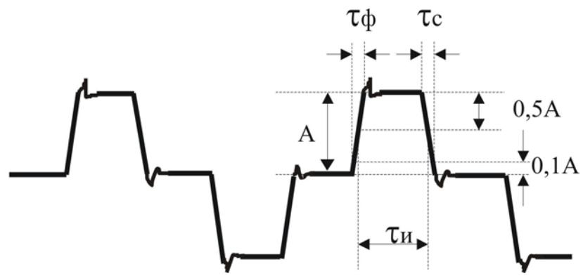
Проведите измерения амплитуды сигнала  $A$ , длительности импульсов  $\tau_i$ , длительности фронта  $\tau_\phi$ , длительности спада  $\tau_c$ .
