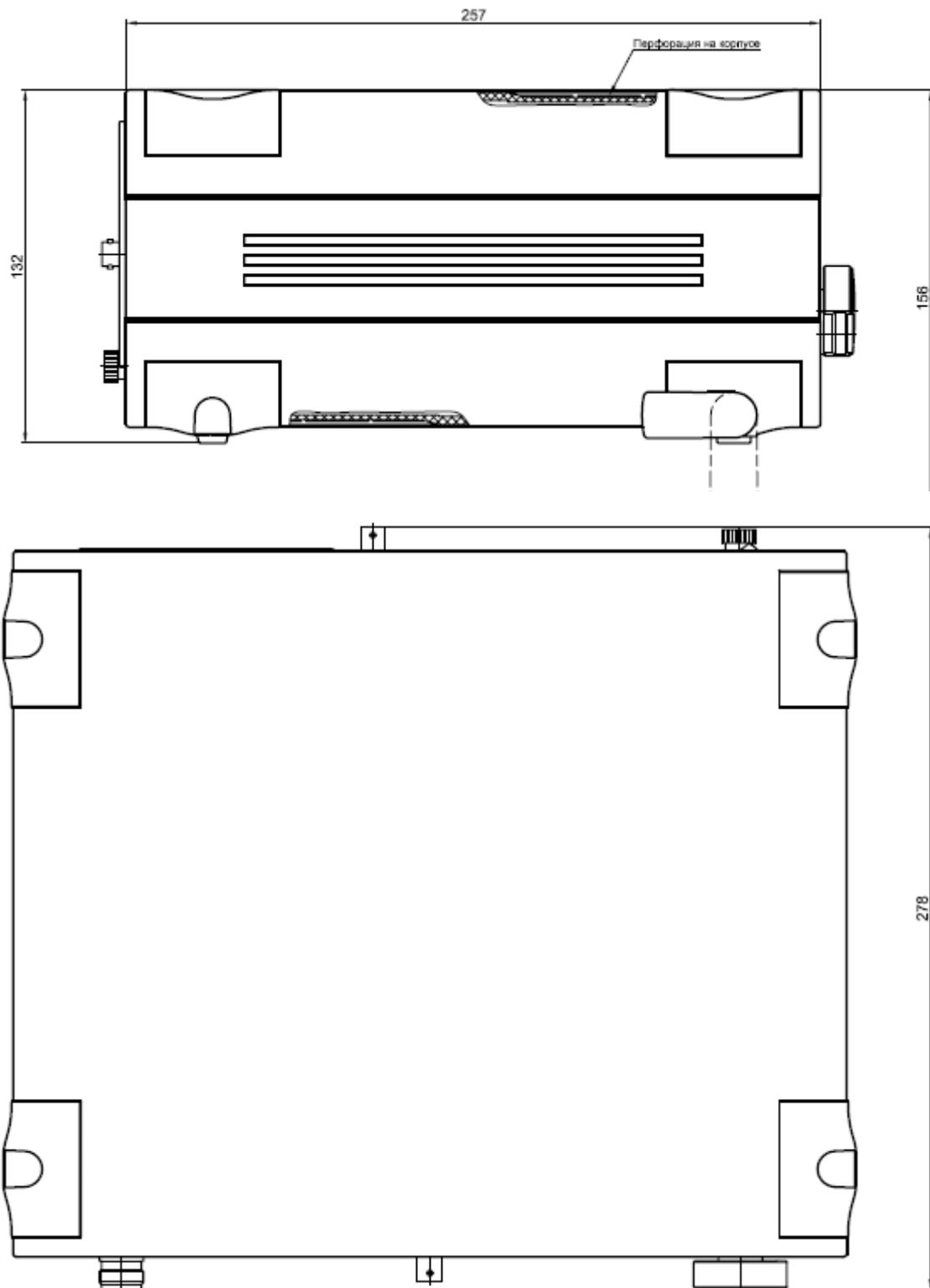
Общий вид генератора Г4-224 и его габаритные размеры
