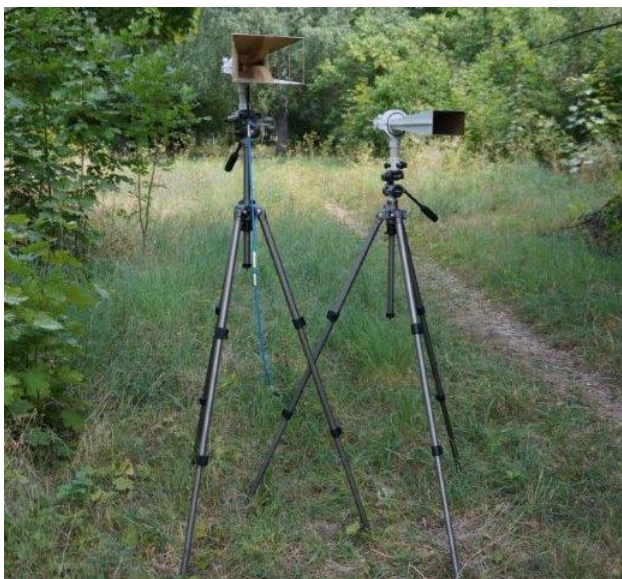
Фото 1. Антенный измерительный комплект на фотоштативах
