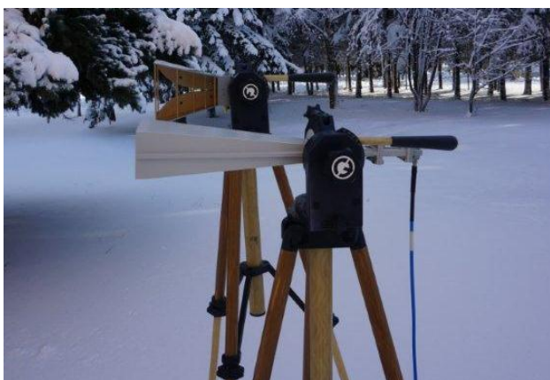
Фото 2. Антенный измерительный комплект на диэлектрических штативах ШАД-01
