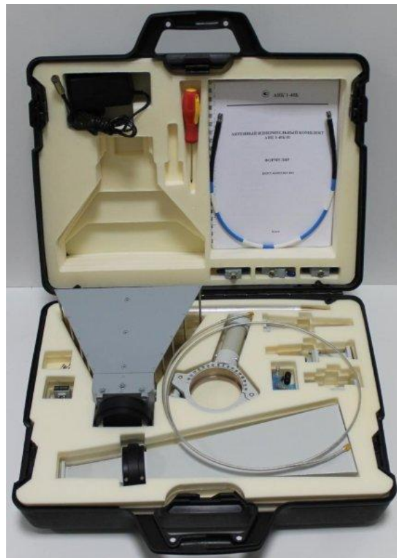
Фото 3. Антенный измерительный комплект АИК 1-40Б/01 в кейс-упаковке
