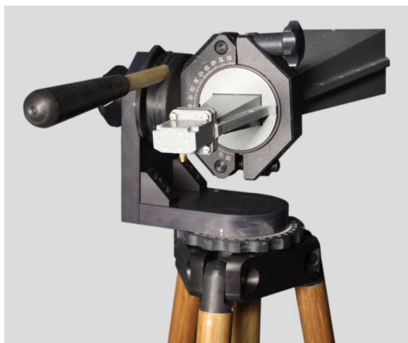
Фото 4 и 5. Антенна П6-123 и П6-140 из состава антенного измерительного комплекта АИК 1-40 Б/01
