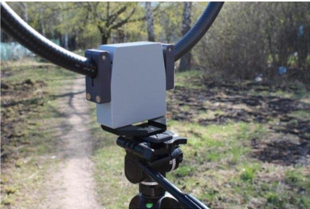
**Фото 1.** Вариант крепления антенны П6-119 на фотоштатив
