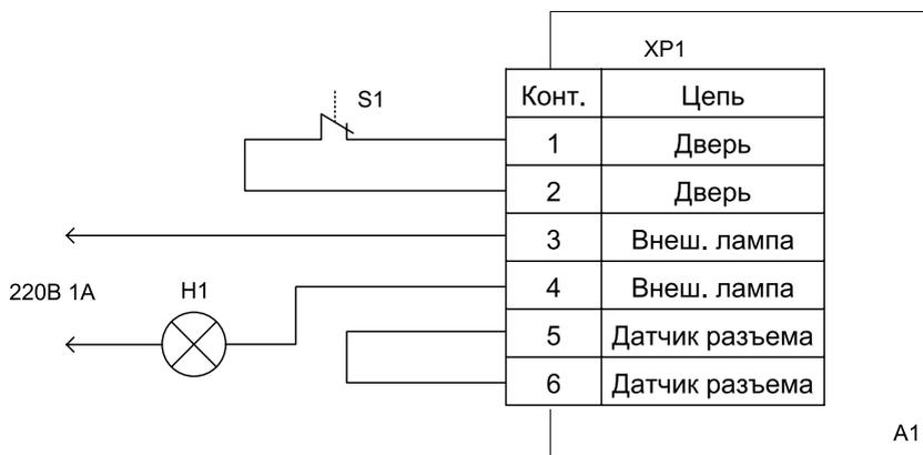
Рис. 3. Схема подключения цепей блокировки и внешней сигнализации.
