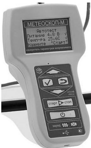
**Рисунок 6.** Измерительно-индикаторный блок
