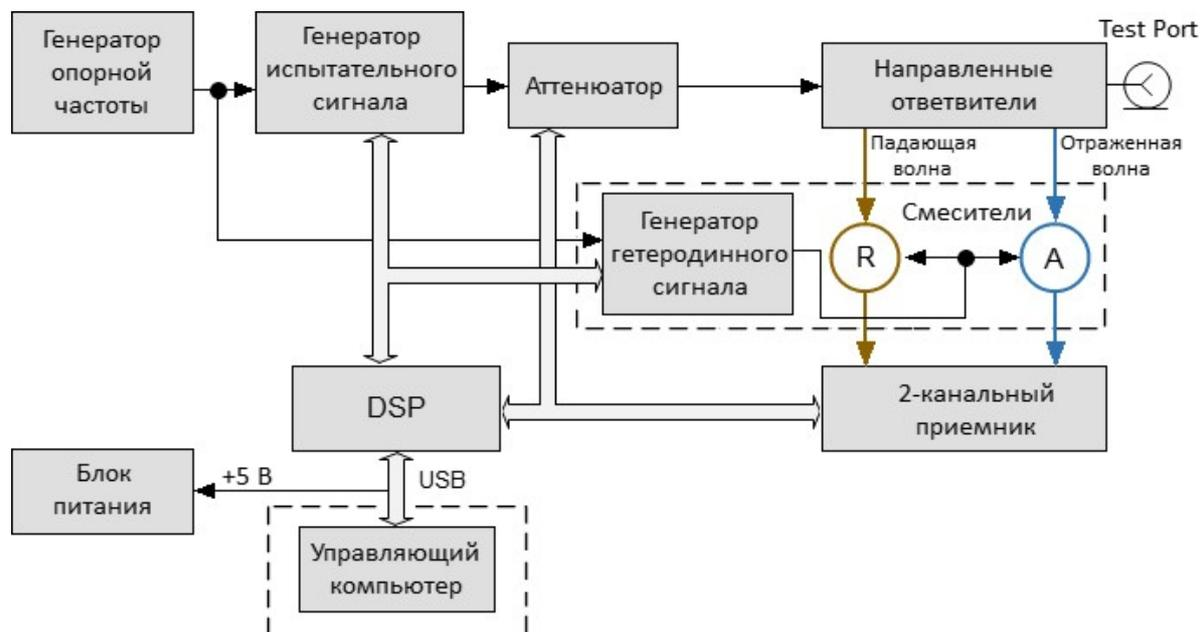
Рисунок 2 – Функциональная схема рефлектометра векторного
