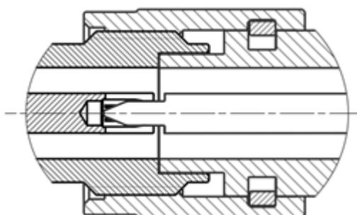
Рисунок 9 – Соединители тип 3,5 мм (розетка слева, вилка справа)
