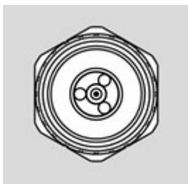
Измерительные порты служат для подключения исследуемого устройства. Измерительный порт выступает как в качестве источника испытательного сигнала, так и в качестве приёмника отраженного сигнала.
