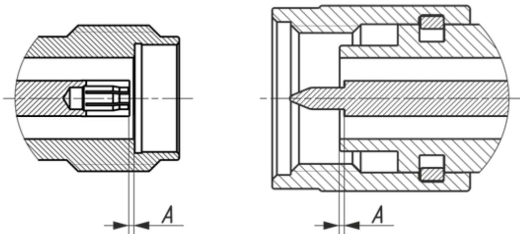
Рисунок 7 – Соединители тип 3,5 мм (розетка и вилка)
