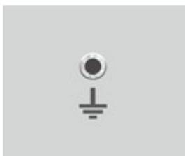
Клемма служит для подключения измерителя к шине защитного заземления. панели.
