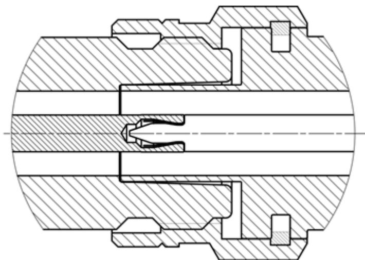
Рисунок 8 – Соединители тип N (розетка слева, вилка справа)
