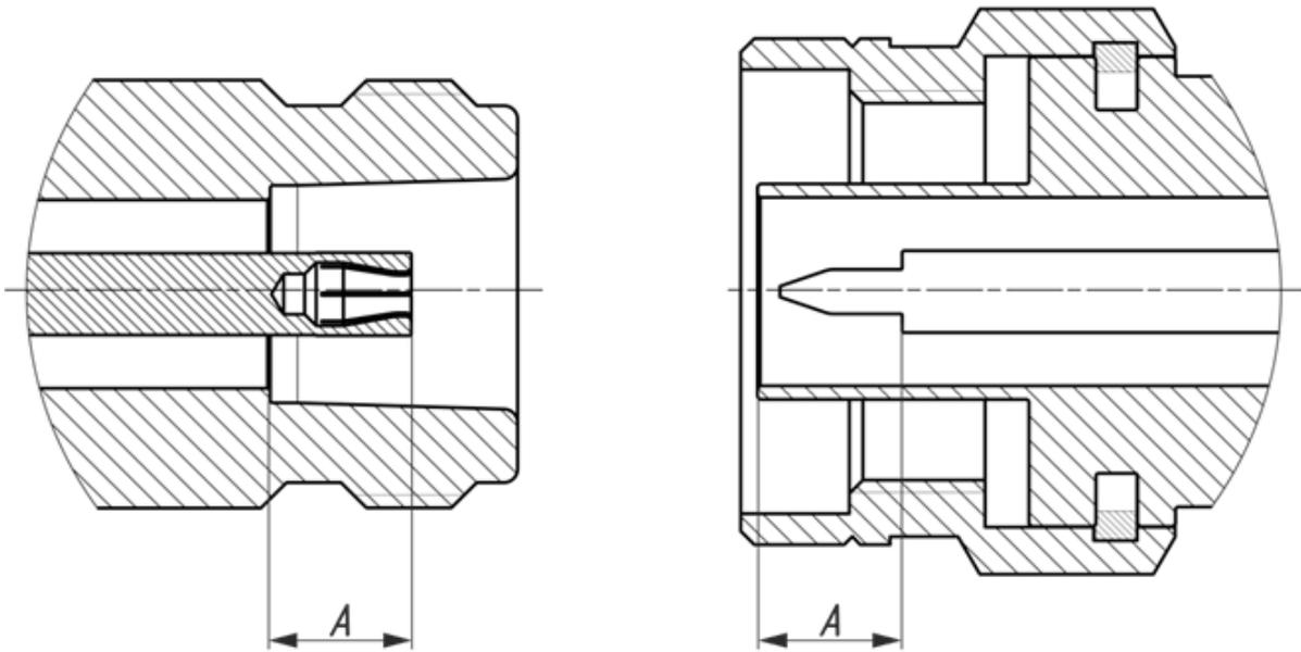
Рисунок 6 – Соединители тип N (розетка и вилка)
