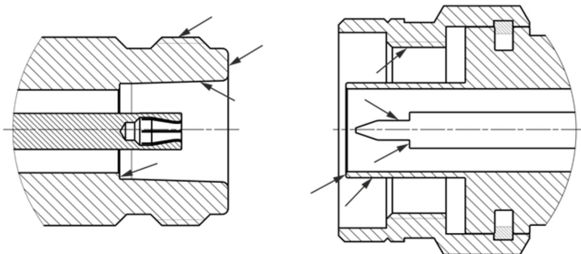
Рисунок 4 – Соединители тип N и III (розетка и вилка)
