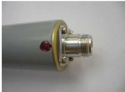
**Фото 5.** Антенна П6-121М1 разъем N-типа
