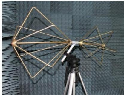
**Фото 2.** Антенна П6-121 на штативе, в рабочем положении
