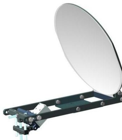
**Рис. 2** 3D модель антенны ЗА1-0,3
